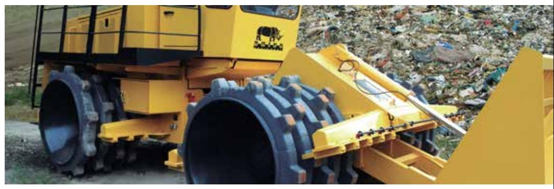
Diseñado para resistir fuerzas de torsión y deformación, el bastidor del extremo del motor de sección en caja proporciona una base sólida para los ejes, el motor y la transmisión.
