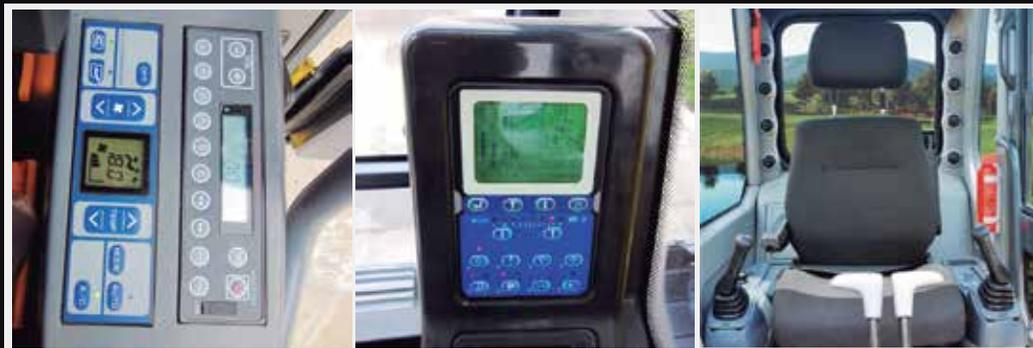
1. El sistema de climatización ajustable estilo automóvil ayuda a mantener el cristal claro y la cabina confortable.
