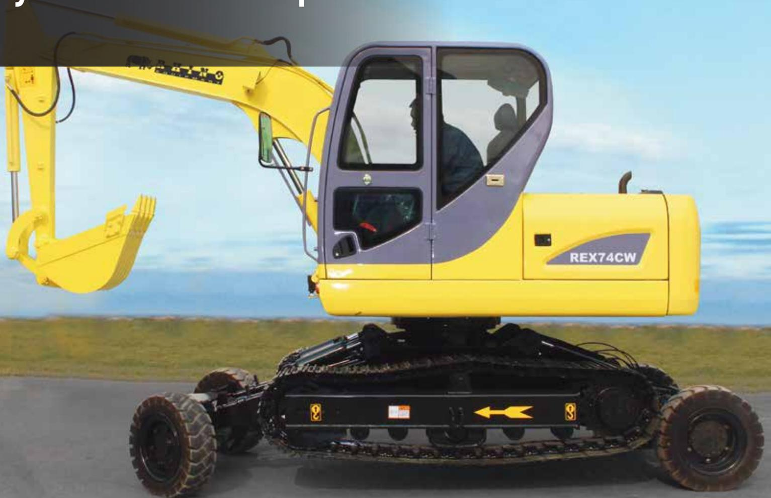
La REX74CW se puede transformar de una excavadora de orugas a una excavadora de ruedas para proporcionar una manera más rápida de transporte desde un sitio a otro; por lo tanto, disminuirán los costos de transporte, y aumentará la vida útil del tren de rodaje. Estas rueda de accionamiento hidráulico se puede quitar fácil y rápidamente si es necesario.
