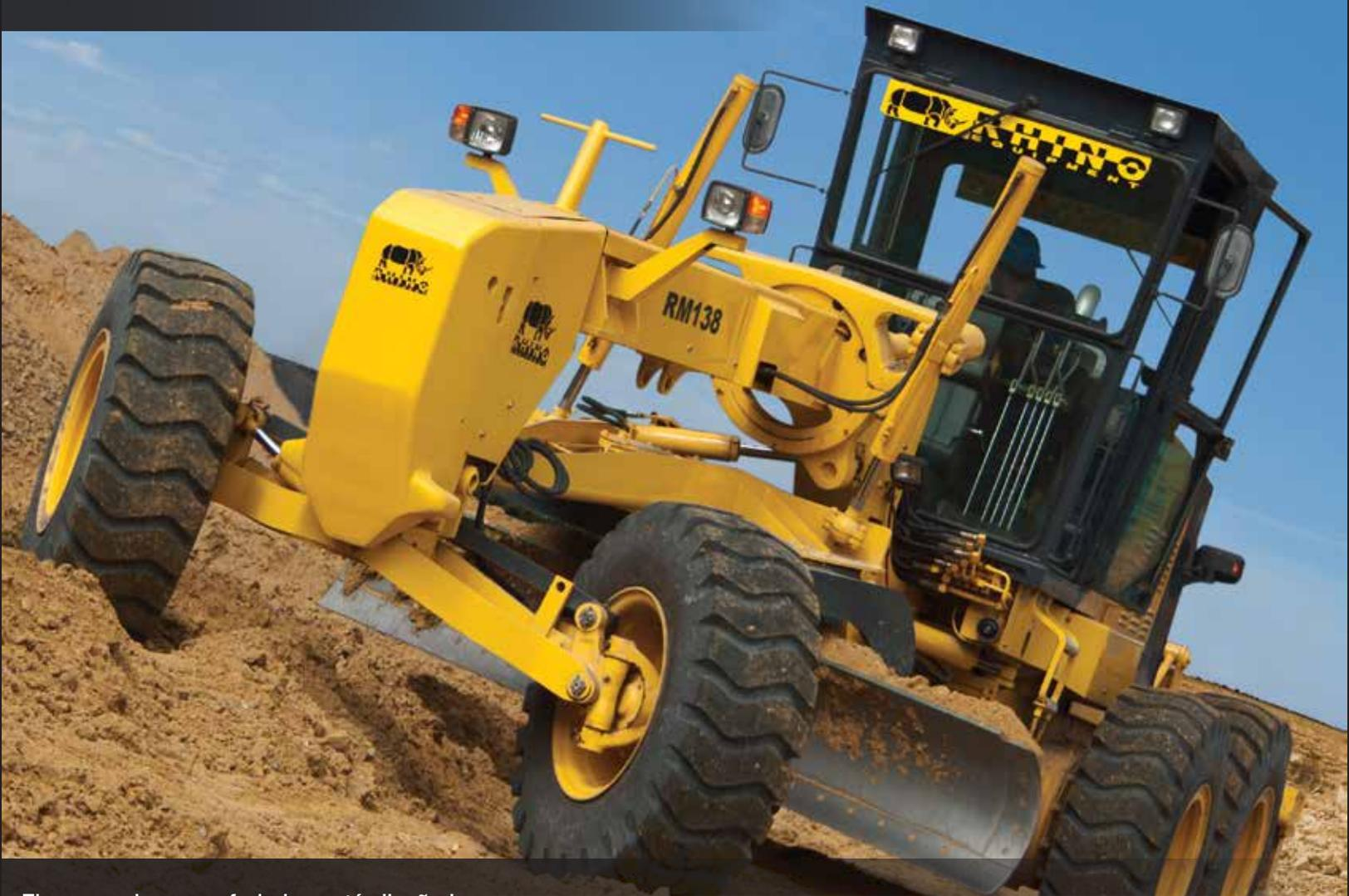
El marco de acero forjado está diseñado para una mayor durabilidad en aplicaciones de trabajo pesado. La estructura del marco utiliza un material duradero y resistente. La parte frontal de los dientes del círculo tienen bajo desgaste y garantizan la fiabilidad de los componentes.
